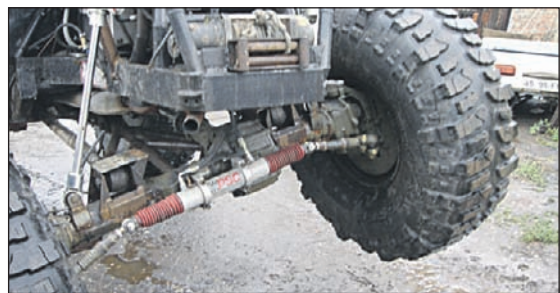
Одно из колес внедорожника можно поднять, остальные останутся на земле (домкрат не нужен)!
