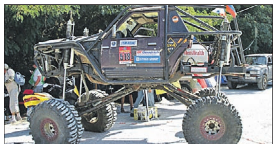
С помощью подвески высоту и без того огромного джипа можно увеличить почти на метр.
