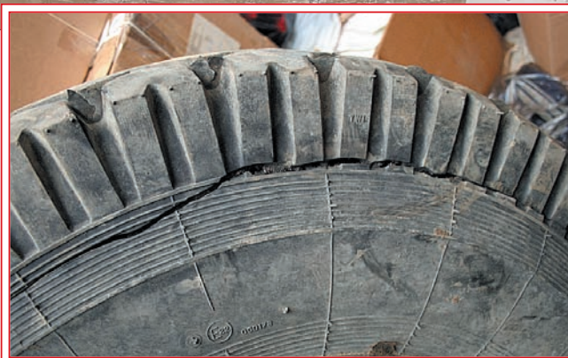
Следователи выясняют, была ли эта трещина в колесе до взрыва.
