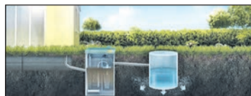
Схема отвода очищенной воды в дренажный колодец
