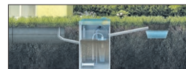
Схема отвода очищенной воды в ливневую канаву
