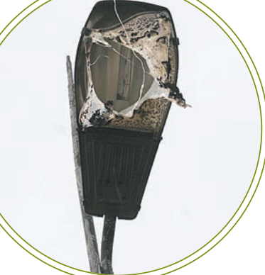
Столб огня от взрыва поднялся на приличную высоту, расплавив плафоны стоящих рядом электроопор.
