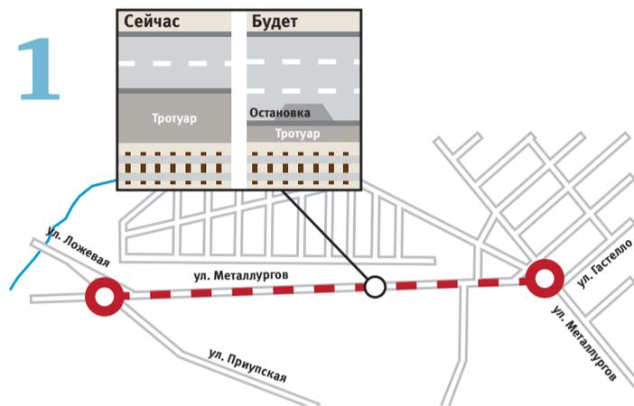
Схема 1. Дорогу на улице Металлургов расширят за счет свободного расстояния от трамвайной линии до проезжей части.
