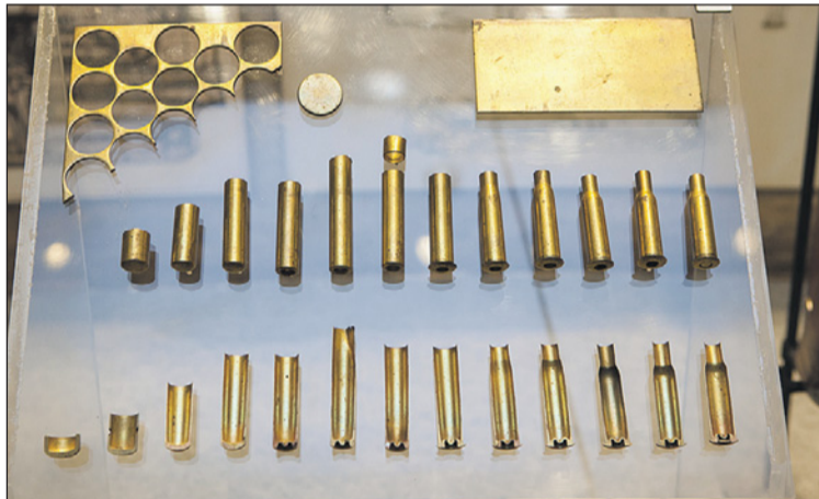
На одной из витрин можно увидеть поэтапное производство гильзы для патрона к винтовке Мосина 7,62x54 мм.
