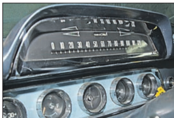
Ленточный спидометр: вместо привычной стрелки – ползущая лента. Как в приемнике!
