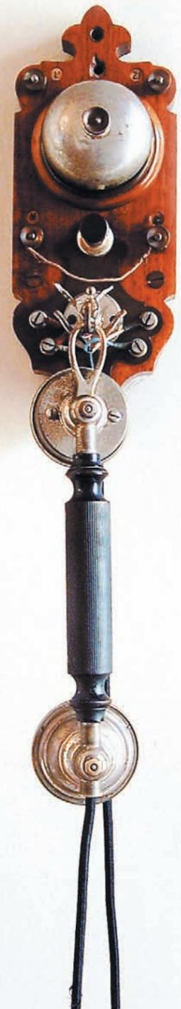
У первых телефонов не было диска для набора номера! «Барышня» на телефонной станции вызывалась простым снятием трубки.
